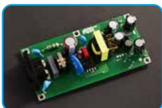
工業電源電路板
